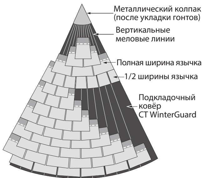
Рис. 9-6. Укладка гонта на округлённую часть крыши.
