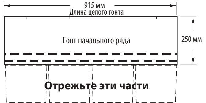
Рис. 14-5. Изготовьте гонты начального ряда, отрезав 20,3 см язычки.
