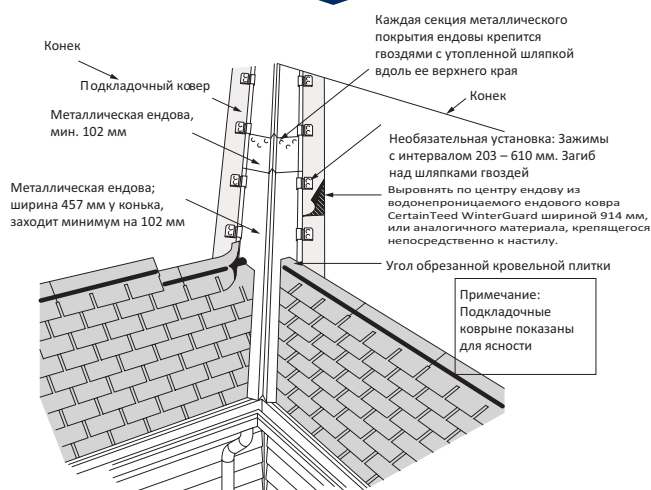
Рис. 6-20: Типичная закрепленная климмерами открытая ендова
