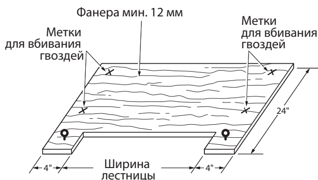
Рис. 1-1: Фанерный щит водосточного жёлоба.
