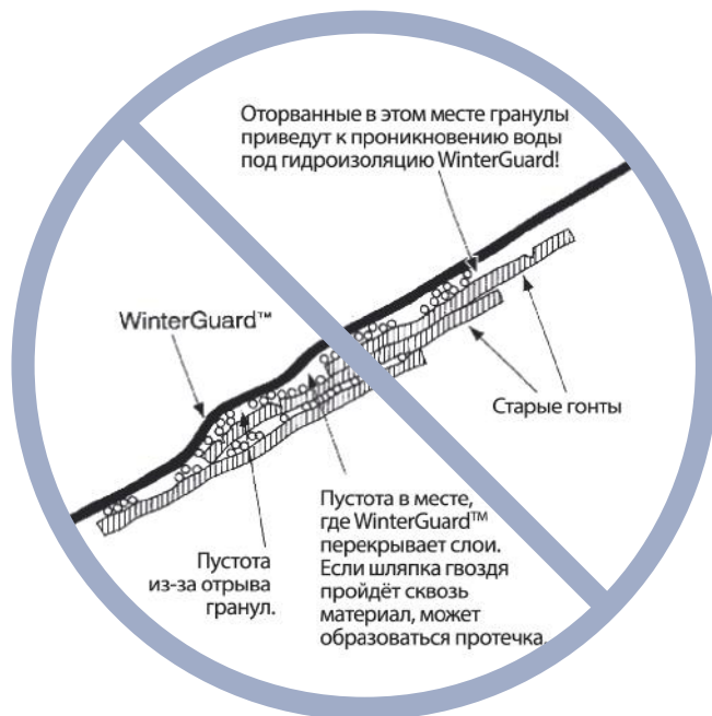
Рис. 5-4. Проблемы, возникающие при укладке WinterGuard на крышу.
