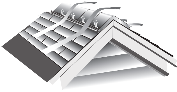
Рис. 7-23. Вентилируемый конёк с внешней перегородкой «вытягивает» воздух из чердачного помещения через обе стороны вентиляционной секции.
