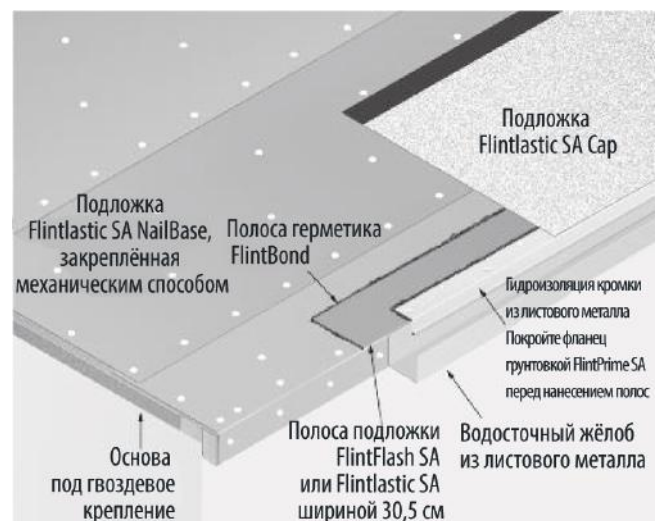
Рис. 5-30. Конструктивные особенности водосточного жёлоба в двухслойной системе.
