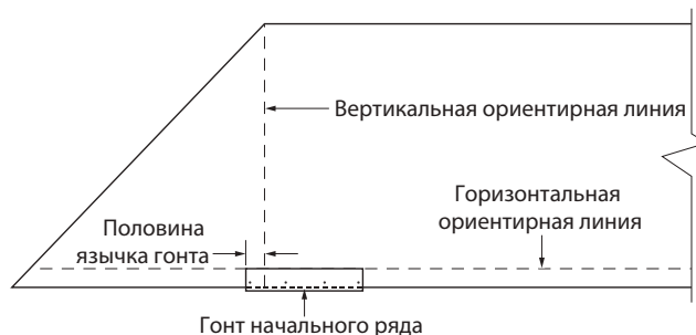
Рис. 9-1. Полосовой гонт начального ряда, перекрывающих вертикальную ориентирную линию.
