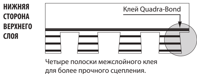
Рис. 12-3. NailTrak™ имеет более широкий участок забивки гвоздей и конструкцию повышенной прочности на основе клея Quadra-Bond.
