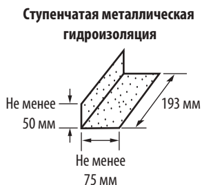
Рис. 12-10. Минимальные размеры ступенчато гидроизоляции.
