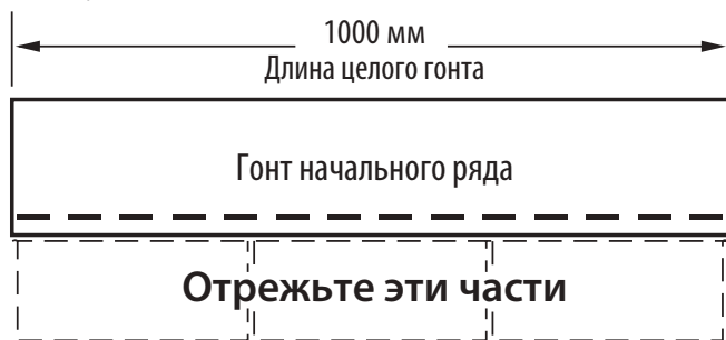
Рис. 10-13. Изготовьте гонты начального ряда, отрезав язычки.
