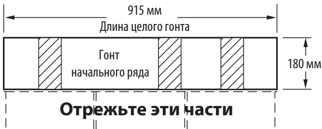
Рис. 13-8. Изготовьте гонты начального ряда, отрезав 5-дюймовые язычки.
