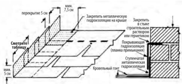
Рис. 6-2: Ступенчатая гидроизоляция боковой стены (см. также Рис. 6-10)
