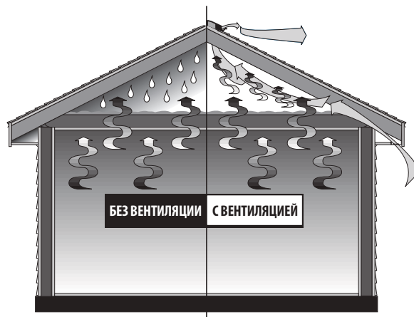
Рис. 7-8. Вентиляция чердачного помещения за счёт теплового эффекта.
