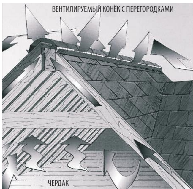
Рис. 7-12. На крышах L-образной и T-образной формы вентиляционные секции должны быть размещены как вдоль длинных, так и вдоль коротких коньков, поскольку все зоны чердачного помещения сопряжены друг с другом. Если высота коньков отличается более чем на 1 м, то вентиляруемым должен быть только самый высокий конёк, либо установите перегородки в чердачном помещении.
