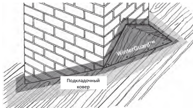
Рис. 6-8: Дымоход через настил крыши.
