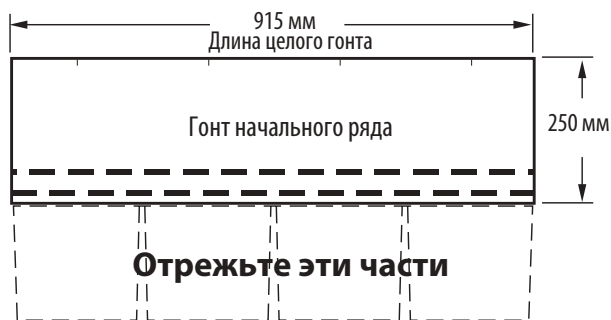
Рис. 14-10. Укладка гонтов начального ряда вдоль краёв ската.
